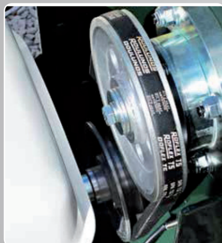
Trasmissione a cinghie con puleggia Belt transmission with pulley Transmission à courroies avec une poulie Transmisión por correa con polea Riemenantrieb mit einer Scheibe Overbrenging met V-snaren en riemschijf Ременная трансмиссия со шкивом
