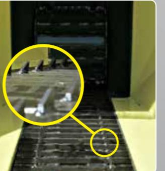
**Nastro di carico in acciaio**
