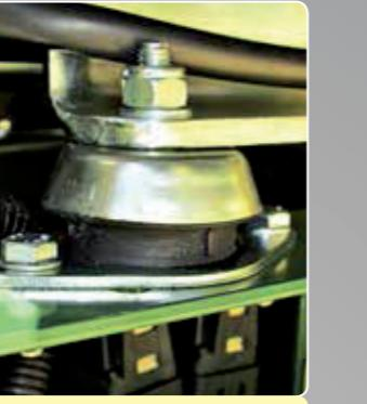
Motore diesel montato su antivibranti
