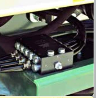
**Impianto centralizzato di lubrificazione**
