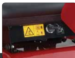
Dispositivo di sicurezza KeyChoice™
