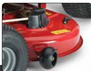
Apparato di taglio flottante
