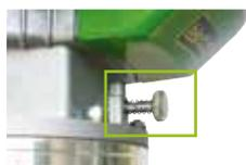
del riduttore, permette di estrarre facilmente dal suolo la punta eventualmente incastrata senza smontarla dalla macchina: la trivella va semplicemente fatta ruotare a motore spento in senso antiorario in modo che la punta si sviti dal terreno.
